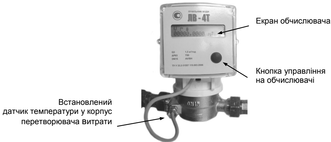
Рис.2 - Встановлений датчик температури і вид лицьової панелі обчислювача
