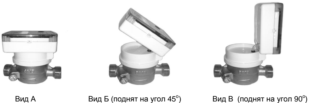
Рис.1 – Фиксация вычислителя (под разным углом наклона) на преобразователе расхода (Вид А, Б, В)
